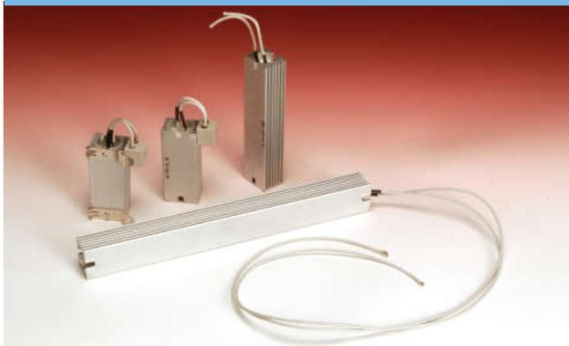
Le resistenze anticondensa vengono utilizzate per ovviare alla creazione della condensa all'interno dei quadri. Sono realizzate con un dissipatore in alluminio anodizzato nel quale viene alloggiato un resistore termostato, il quale può essere alimentato con tensione Variabile da 12Vca a 380Vca a seconda della necessità del cliente ottenendo una temperatura superficiale costante di circa 70°C.
