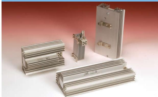
Le resistenze anticondensa vengono utilizzate per ovviare alla creazione della condensa all'interno dei quadri. Sono realizzate con un dissipatore in alluminio anodizzato nel quale viene alloggiato un termistore PTC che consente di alimentare la resistenza con tensione variabile da 110Vca/cd a 260Vca/cc ottenendo una temperatura superficiale costante di circa 70/80°C.
